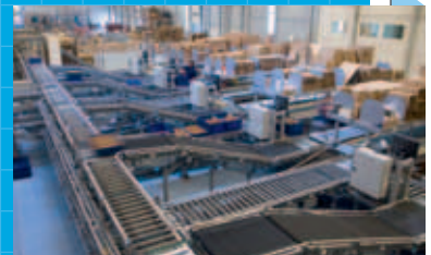
Mecan keskusvarastossa Eskilstunassa Knapp-Movingin robottinosturit vievät tuotteet oikeisiin keräilypisteisiin.
